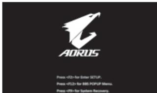
Durante el proceso de encendido del equipo portátil, presione sin soltar la tecla F9 para iniciar la herramienta.
