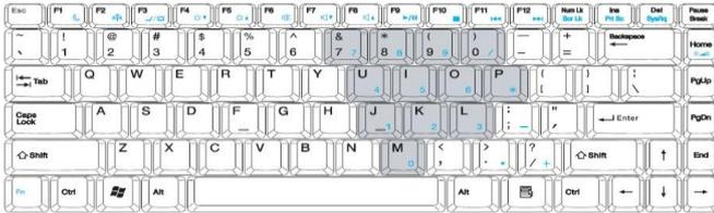
عملکرد کلیدهای عددی داخلی تعبیه شده درون صفحه کلید مانند کلیدهای عددی در یک صفحه کلید معمولی است. این کلیدها با علائم کوچکی که در قسمت پایین و سمت چپ کلیدها واقع شده است مشخص می شوند.
