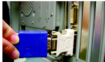
使用 DVI-I 轉 D-sub 轉接頭連接 VGA 螢幕
