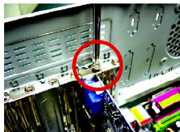
2. 將螺絲鎖上使繪圖加速卡能確實的固定在機殼上。
