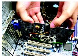
1. 從防靜電的包裝袋中將您的繪圖加速卡拿出來。將繪圖加速卡很小心並且很確
