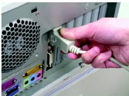
3. 將您機器的外殼重新裝上，並將螢幕的接腳插頭插在繪圖加速卡上的螢幕接頭。
