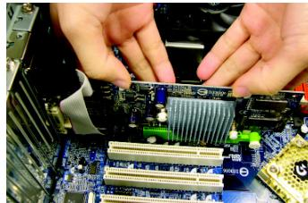
2. 將螺絲鎖上使顯示卡能確實的固定在機殼上。
