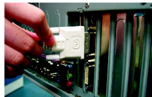
フラットパネルを接続
