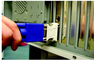
使用 DVI-I 轉 D-sub 轉接頭連接 VGA 螢幕
