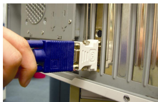
Conectar un monitor VGA a través del adaptador DVI-I a D-sub
