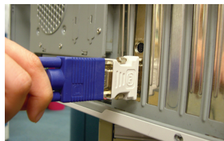
Подключение VGA-монитора через переходник DVI-I / D-sub
