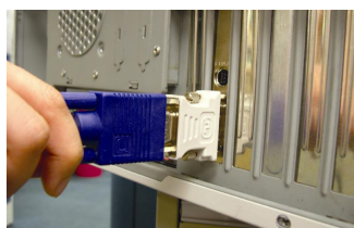
Connettere uno schermo VGA con il DVI-I con un adattatore D-sub.
