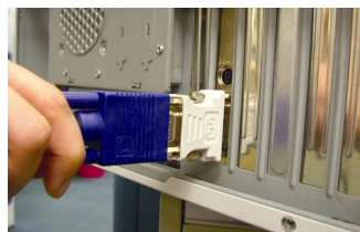
Einen VGA-Monitor über den DVI-I-zu-D-Sub-Adapter anschließen
