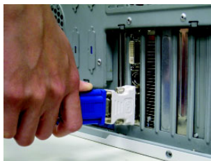
使用 DVI-I 轉 D-sub 轉接頭連接 D-Sub 螢幕
