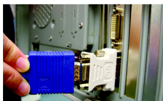
DVI-I-D-sub アダプタを経由して VGA モニタを接続します
