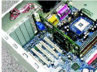
3. 從機殼上移除擴充擋板及螺絲，如果您的機器上有其他的繪圖加速卡，請您務必將其移除。
