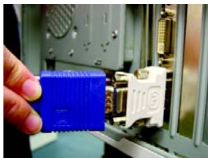
使用 DVI-I 轉 D-Sub 轉接器連接 D-Sub 螢幕
