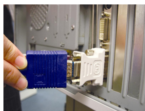
Einen VGA-Monitor über den DVI-I-zu-D-Sub-Adapter anschließen
