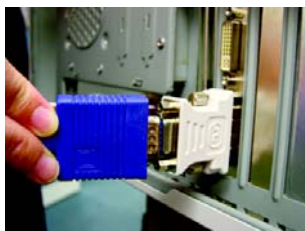
使用 DVI-I 轉 D-sub 轉接頭連接 VGA 螢幕
