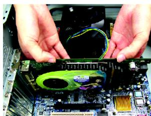
5. カードをねじで固定し、コンピュータのカバーを戻してください。
