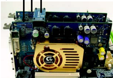
兩張相同型號的顯示卡 (例：GV-NX66T128D) SLI 連結器 (由主機板廠商提供)
