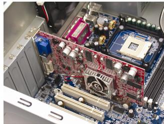
3. Entfernen Sie die Grafikkarte vom Computer, falls vorhanden. Sollte der Computer in der Platine integrierte Grafikfunktionen besitzen, kann es notwendig sein diese auf der Hauptplatine zu deaktivieren. Einzelheiten dazu sind aus der Computeranleitung ersichtlich.
