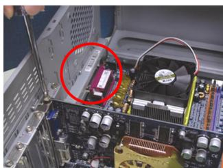
6. Enchufe el cable expuesto dentro de la tarjeta; después encienda el ordenador y el monitor. Si su tarjeta gráfica viene con un conector DVI, se puede conectar un panel visualizador plano al conector apropiado, como se muestra abajo...
