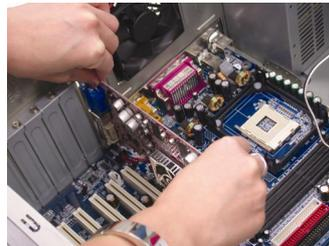
4. Localice el slot AGP. Si es necesario, quite la cubierta de metal del slot; después alinee la tarjeta gráfica con el slot AGP, y presione firmemente hasta que la tarjeta este completamente insertada.
