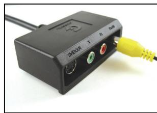
(3) اتصال خروجی AV اگر تلویزیون شما از اتصال دهنده ویدیویی مرکب پشتیبانی می کند می توانید یک کابل RCA را از مانیتور خود به اتصال دهنده خروجی AV بروی مبدل متصل کنید.
