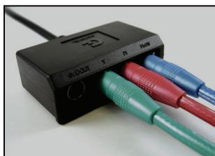
(1) اتصال HDTV (تلویزیون با وضوح بالا) کابل HDTV خود را با توجه به رنگ آن ها به اتصال دهنده های هم رنگ بروی مبدل نصب نمایید.
