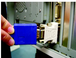
使用 DVI-I 轉 D-sub 轉接頭連接 VGA 螢幕
