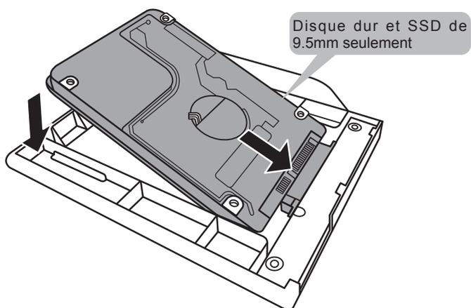
Connectez le disque dur ou le SSD en le positionnant en face du connecteur de la baie.
