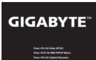
Durante la computadora portátil este en el proceso de encendido, presione y mantenga la tecla F9 para ejecutar la herramienta.
