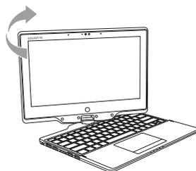
4. Coloque la pantalla se volvió hacia abajo en posición plana. El teclado será cubierta por la pantalla. Utilice el lápiz o simplemente toque la pantalla para operar como un U2142 Tablet PC.
