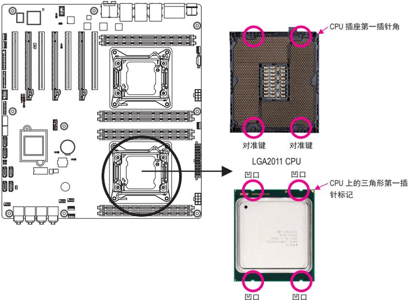
B. 按照下述步骤将 CPU 正确安装到主板 CPU 插座。
