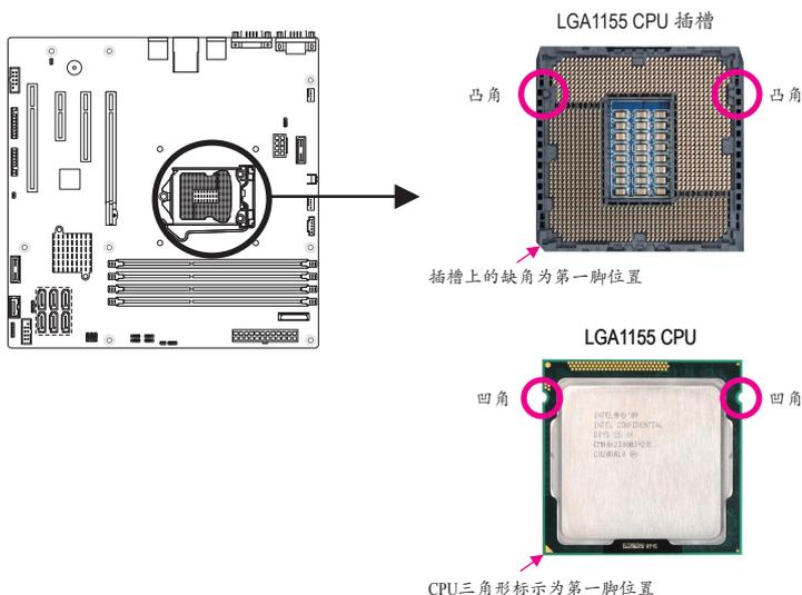
B. 请按下列步骤将CPU正确地安装于主板的CPU插槽内。
