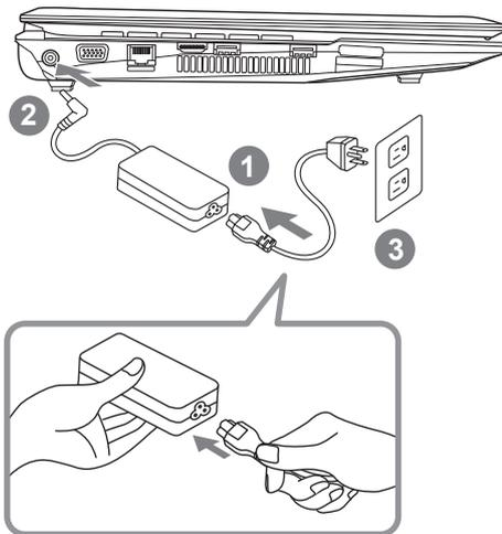
1. 將電源線接上變壓器。
