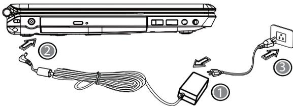
1. 将电源线接上AC变压器。
