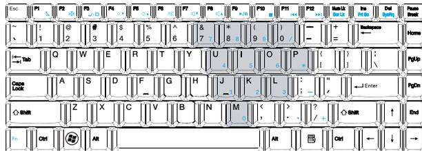
内置的数字键盘功能和桌上型计算机的数字键盘相同。您可依照按键右上方的小字来判断此按键代表何种输入字符。
