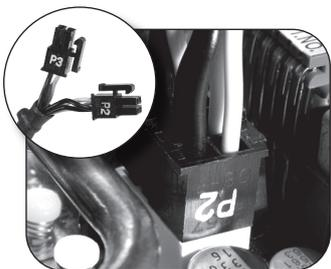
4+4-Pin ATX/EPS CPU-Netzanschlußstecker
