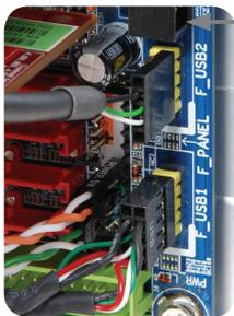
13. 如要激活软件控制功能，请将USB接头从电源供应器连接到主板。如果主板上没有USB接头，使用USB转接器来连接到主板后方，或是使用有USB I/O埠的扩充卡。(仅限于Odin GT系列)
