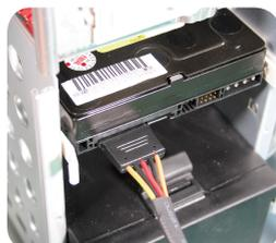
11. 用户可以使用智能型缆线管理一风扇调速器电源接头, 连接两个3-pin的系统风扇。如此可让Odin GT电源供应器能监控你所连接的风扇的速度(仅限于Odin GT)。
