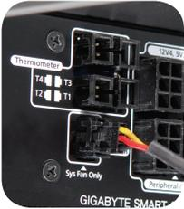
11. Mit einem Smart Kabelmanagement Netzanschluss für die Lüftergeschwindigkeitskontrolle, können Anwender zwei 3-Pin System-Lüfter anschließen. Dies erlaubt es der Odin GT Energieversorgung die Geschwindigkeit der Lüfter, die Sie installiert haben, zu überwachen und kontrollieren (nur Odin GT). Hinweis: Verbinden Sie nicht mit dem CPU-Lüfter.
