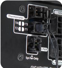
12. Anschluss des Smart Kabelmanagement Thermalfühlerkabels, verwenden Sie das Thermalklebeband um den Fühler auf die Oberfläche, wo Sie die Temperatur messen wollen, zu kleben. Das Thermalklebeband besitzt Isolierfähigkeit. Es kann in Hochtemperaturumgebungen verwendet werden. Hinweis: Bitte platzieren Sie den Thermalfühler zwischen der CPU und dem Lüfter; es wird den Thermalfühler und die CPU beschädigen. (nur Odin GT Serie)
