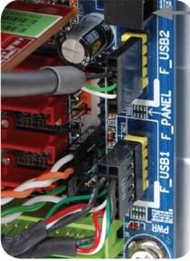
13. Um die Software-Kontrollfunktion einzuschalten, verbinden Sie den USB Anschluss der Energieversorgung mit dem Motherboard. Falls da kein USB Anschluss auf dem Motherboard ist, verwenden Sie bitte den USB Konverter um die Verbindung zur Rückseite des Motherboards oder einer Add-On-Karte mit einem USB I/O port herzustellen. (Nur Odin GT Serie)
