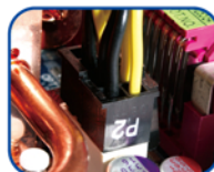
4+4ピンATX/EPS CPU CPU電源コネクタ
