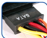
Connecteur pour disque dur S-ATA
