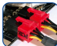
PCI-E 2.0, connecteur 6+2 broches
