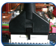
Connecteur d'alimentation principal 24 broches
