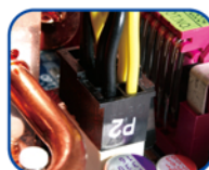
Connecteur d'alimentation du processeur 4+4 broches ATX/EPS
