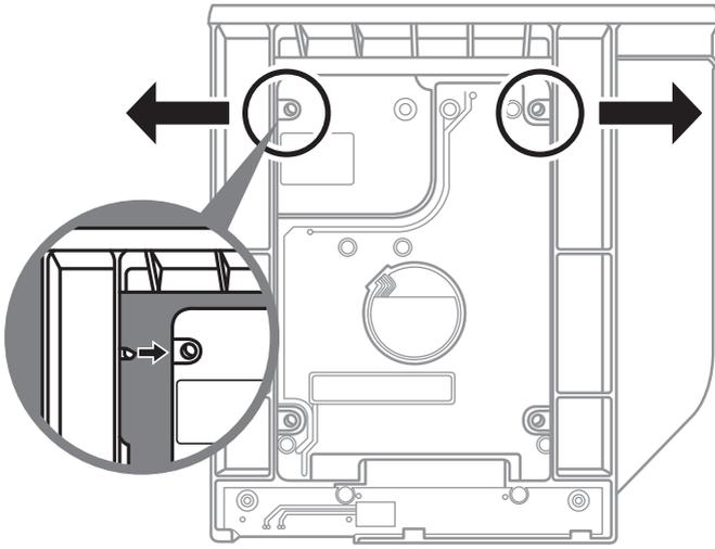
將硬碟推入框架內側的卡栓中。
