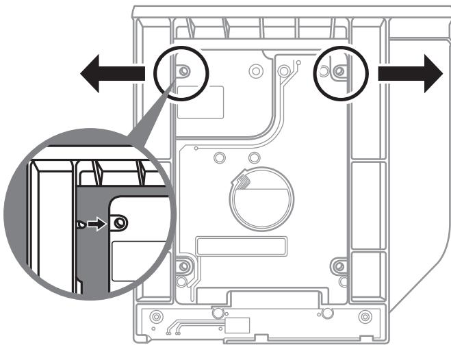
Соедините штырьки HDD или SSD, задвинув его в разъём.
