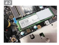
• Insérez le SSD dans l'emplacement M.2 et vissez la vis pour le fixer.
