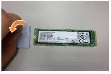
Prenez le patch thermique et otez la protection du patch thermique avant de le coller sur le SSD.
