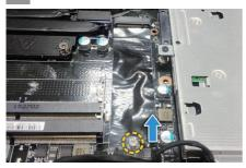
• Ouvrez le panneau arrière du PC et libérez la vis sur l'emplacement du SSD M.2
