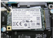
• 将您的 mSATA SSD 倾斜 45 度角插回至系统中的 mSATA 插槽,并锁上螺丝。
