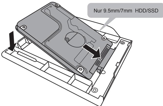
Verbinden Sie die HDD, bzw. HDD/ SSD, indem Sie das Laufwerk in den Rahmen schieben.
