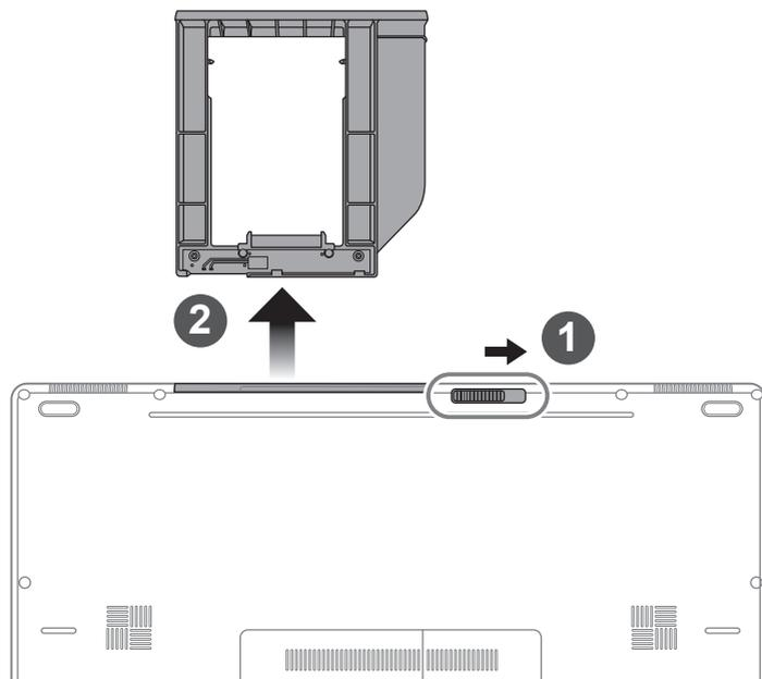
1 Разблокируйте фиксатор отсека.
