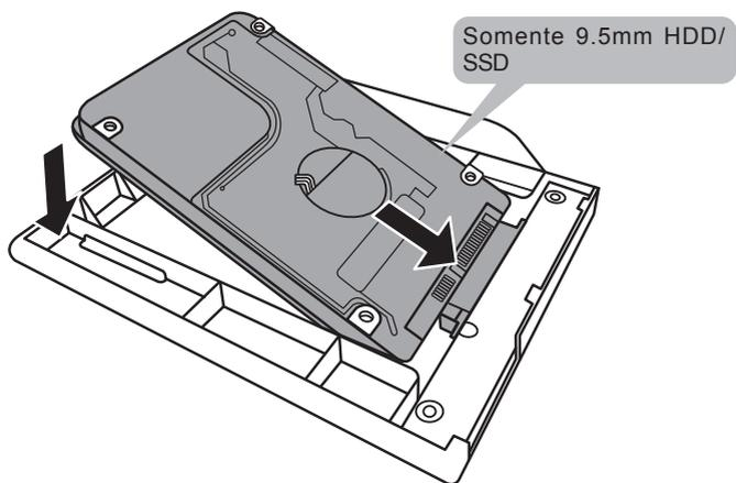
Conecte o pino da HDD ou SSD deslocando-se para o conector
