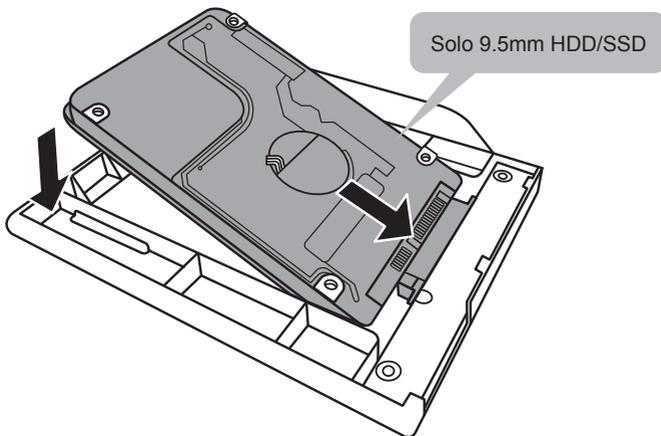
Conecte el HDD o SSD pin deslizándolo en el conector.
