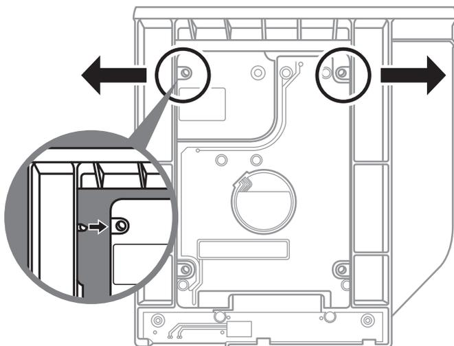
Соедините штырьки HDD или SSD, задвинув его в разъем.
