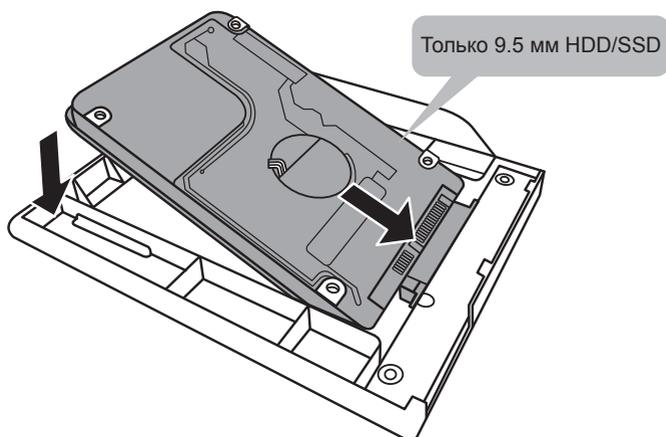
Соедините штырьки HDD или SSD, задвинув его в разъём.
