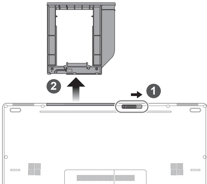
1 | Разблокируйте фиксатор отсека.
