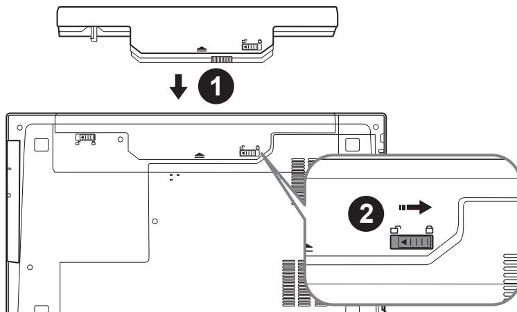
**Для установки батареи, пожалуйста, следуйте следующим инструкциям:**
