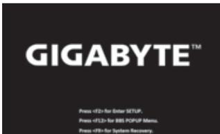
Durante la computadora portátil este en el proceso de encendido, presione y mantenga la tecla F9 para ejecutar la herramienta.
