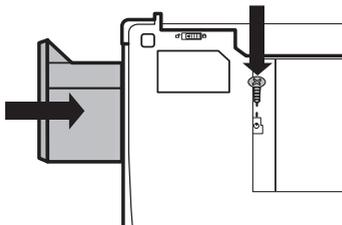
HDDをパソコンにインストールし、ネジを締めてください。
