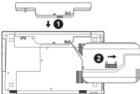
以下のステップで電池を設置してください：
