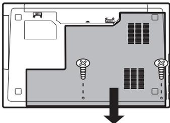
2本のネジを外し、バックカバーを外してください。
