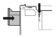
• 將硬碟裝入筆電,鎖上螺絲,完成。
