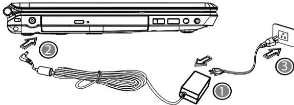
1. Schließen Sie das Netzkabel an das Netzteil an.
