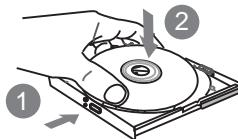
1. 請按下光碟機開啟按鈕，將會彈出碟盤，再將碟盤輕輕的往外拉出。
