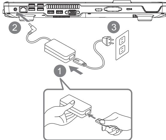
1. 將電源轉接器插入擴充基座左側的電源輸入插孔。
