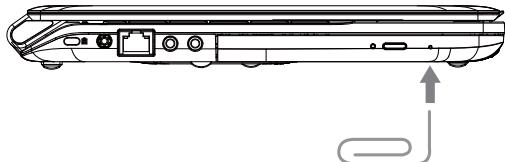
如發生光碟機無法開啟的狀況時須啟用緊急開啟裝置。找一個細長的物品例如迴紋針，輕輕的置入光碟機邊緣的小洞中，接著往內按壓直到碟盤彈出為止，此方式僅適用於碟盤卡住而無法正常使用光碟機開啟按鈕。
