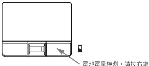
按壓一次後，以6盞LED燈來表示電池的電量，分為1~6種等級；LED燈亮的越多表示電池中的電量越充足。
