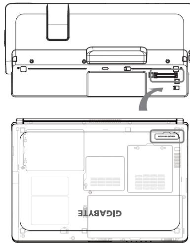
在將電腦嵌入擴充基座之前請確定基座已經接上電源。將電腦與基座如上述圖示對齊之後，輕輕地將電腦的基座連接埠與基座本體的連接埠扣上，確定位置無誤之後，再稍加施力下壓以順利連接電腦與基座。如果操作無誤，您應該會清楚聽到連接埠扣上的聲音，電池指示燈也會適當亮起。
