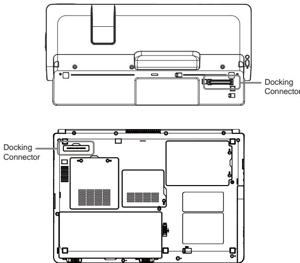
從上圖中可以看出位於筆記型電腦與擴充基座上的兩個擴充基座連接埠位置。請注意當您將筆記型電腦的上蓋面向自己（上蓋的GIGABYTE標誌此時為上下顛倒）時，電腦底部的基座連接埠和擴充基座本體上面的連接埠應該會在同一個方位（也就是您的右手邊位置）。在進行實際連接之前請先留意此方位。
