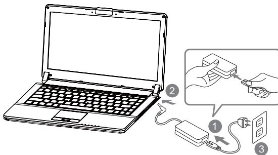
1. 將電源線接上電源轉換器。
